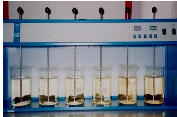
Fig. 1. Jar test apparatus
